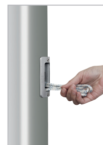
Nach dem Hissen: PES-Seil straff in Seilklampe eindrücken, in Schlaufen legen und als Bündel in Bediengehäuse stecken, Türchen versperren.
