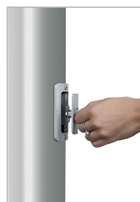
Bediengehäuse SFS: Türchen entsperren, PES-Hissseil entnehmen, durch horizontales Ziehen aus Belegklampe lösen.
