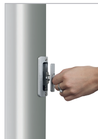
Bediengehäuse SFS: Türchen entsperren, PES-Hisseil entnehmen, durch horizontales Ziehen aus Belegklampe lösen.
